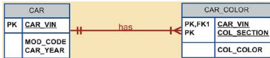
รูปที่ 4.5 การเพิ่มเอ็นทิตีสำหรับจัดเก็บข้อมูลในแอทริบิวที่มีลักษณะเป็น multivalued attribute
